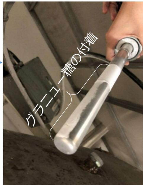
※写真：グラニュー糖製品タンクでアドミタンス式レベルスイッチを使用後、取り出した様子
