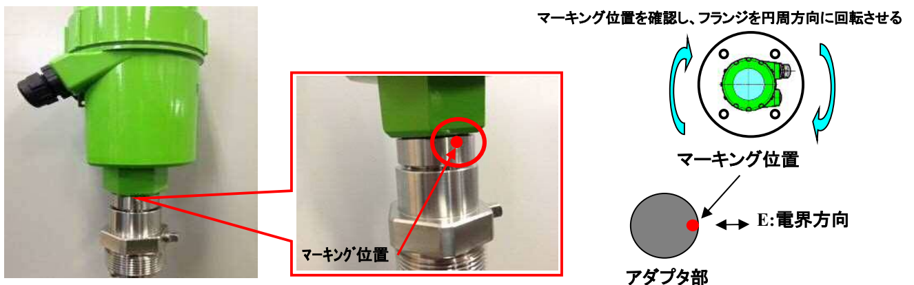
第8図. 取付方向図
