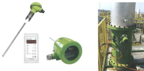
↑「摩擦電荷方式ダストモニタ」ダストモニタは、粒子径0.3～100μmまでの全ての粉体の検出が可能。250℃、200kPaまで標準対応
