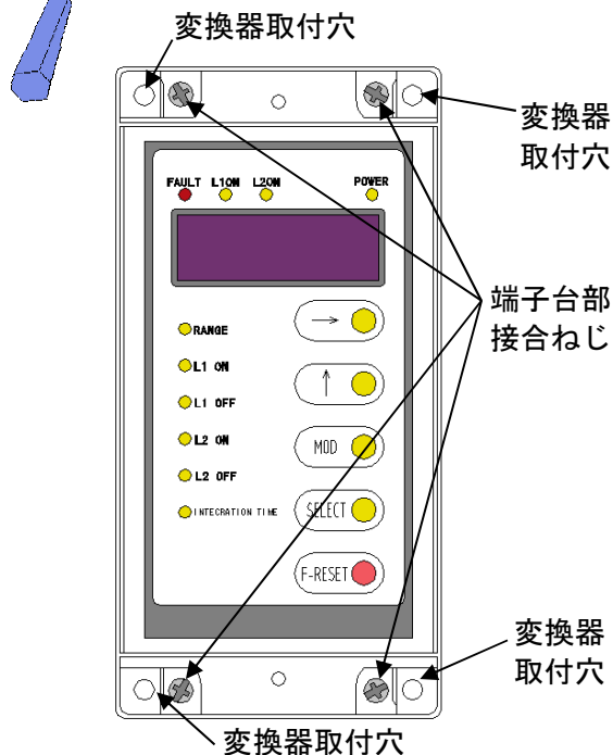
第7図 端子台部と本体部の接合ねじ
