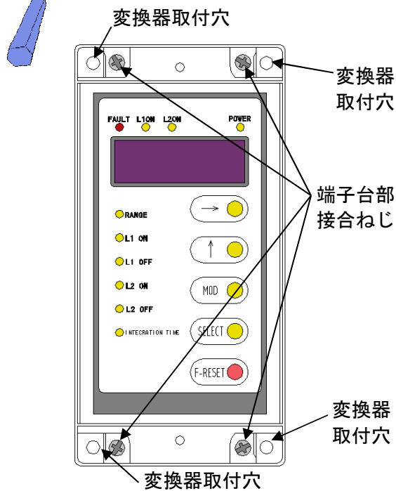
第7図 端子台部と本体部の接合ねじ
