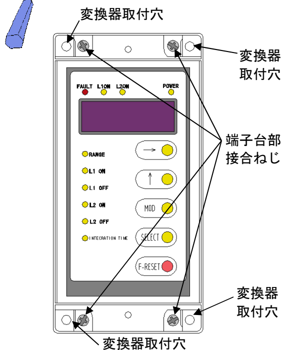
第8図 端子台部と本体部の接合ねじ
