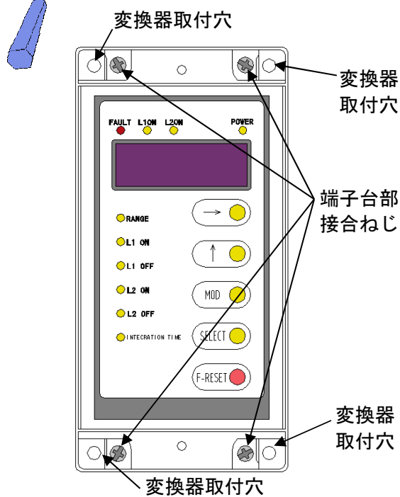
第8図 端子台部と本体部の接合ねじ
